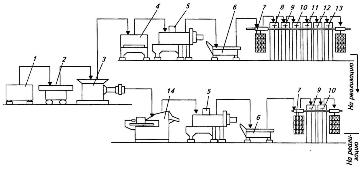
Рисунок 3 – Схема технологической линии производства колбас
