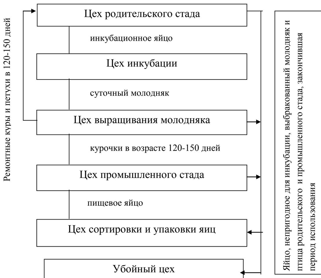
Рисунок 3 – Схема технологии производства яиц
