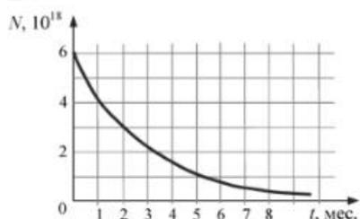
На рисунке представлен график изменения числа ядер находящегося в пробирке радиоактивного изотопа с течением времени. Каков период полураспада этого изотопа?
