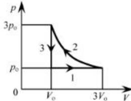
На  $pV$ -диаграмме отображена последовательность трёх процессов (1 → 2 → 3) изменения состояния 2 моль идеального газа. Какова эта последовательность процессов в газе?
